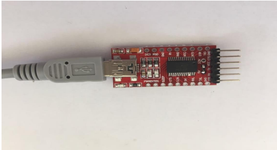
图表 3-3 USB 转接板与 Micro-USB 物理连接图
